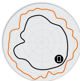
3. ábra R760 5 GHz-es Azimuth (vízszintes irányú) antenna mintázata
