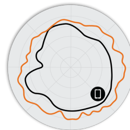
4. ábra R760 6 GHz-es Azimuth (vízszintes irányú) antenna mintázata
