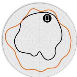
2. ábra R760 2,4 GHz-es Azimuth (vízszintes irányú) antenna mintázata
