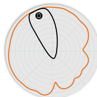
Rys. 5. Charakterystyki anten H350 5 GHz w pionie
