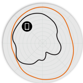
Rys. 2. Charakterystyki anten H350 2,4 GHz w kierunku azymutu
