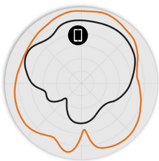
Rys. 3. Charakterystyki anten H350 5 GHz w kierunku azymutu
