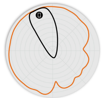
Rysunek 5. Charakterystyki anten H550 5 GHz w elewacji
