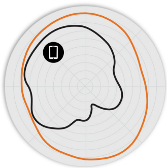
Rysunek 2. Charakterystyki anten H550 2,4 GHz w azymucie
