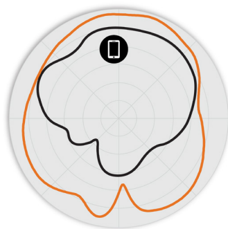
Rysunek 3. Charakterystyki anten H550 5 GHz w azymucie
