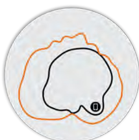
Rys. 3. Charakterystyki anten R350 5 GHz w kierunku azymutu
