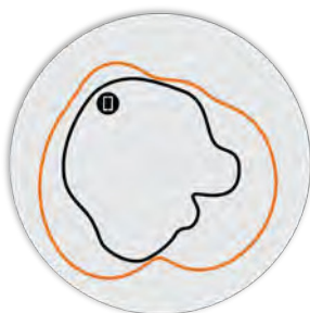
Rys. 2. Charakterystyki anten R350 2,4 GHz w kierunku azymutu
