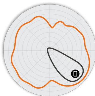
Rys. 4. Charakterystyki anten R550 2,4 GHz w pionie
