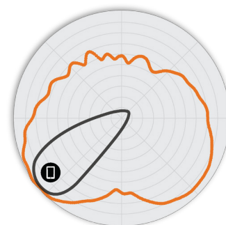
Rys. 5. Charakterystyki anten R550 5 GHz w pionie
