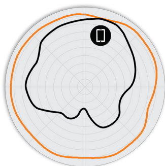
Rys. 2. Charakterystyki anten R650 2,4 GHz w kierunku azymutu
