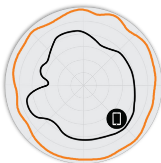
Rys. 3. Charakterystyki anten R650 5 GHz w kierunku azymutu
