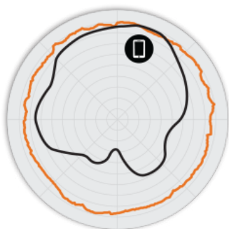
Rys. 2. Charakterystyki anten R750 2,4 GHz w kierunku azymutu
