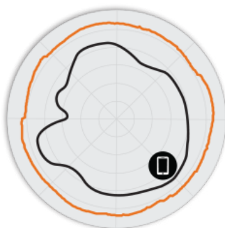
Rys. 3. Charakterystyki anten R750 5 GHz w kierunku azymutu
