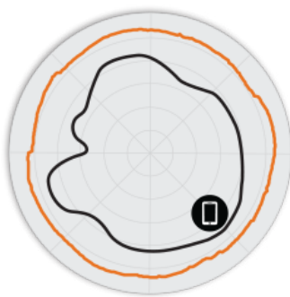
Rys. 3. Charakterystyki anten R850 5 GHz w kierunku azymutu
