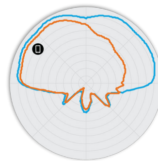
Rys. 5. Charakterystyki anten R850 5 GHz w pionie
