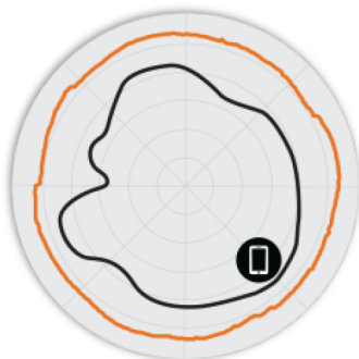
Rys. 3. Charakterystyki anten T750 5 GHz w kierunku azymutu
