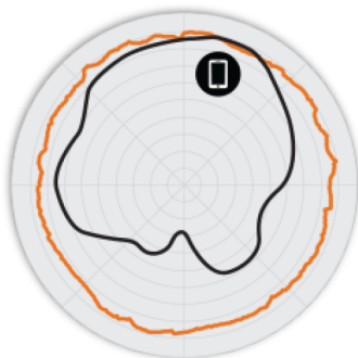
Rys. 2. Charakterystyki anten T750 2,4 GHz w kierunku azymutu
