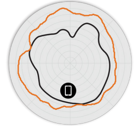
7. ábra R770 6GHz-es Elevation (függőleges irányú) antenna mintázata
