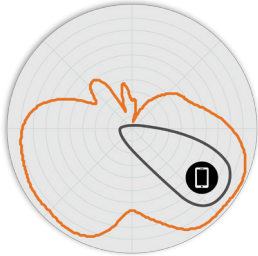
5. ábra R770 2,4 GHz-es Elevation (függőleges irányú) antenna mintázata
