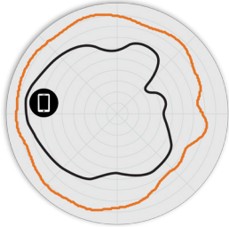
5. ábra R770 2,4 GHz-es Elevation (függőleges irányú) antenna mintázata
