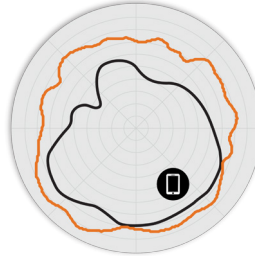
6. ábra R770 5 GHz-es Elevation (függőleges irányú) antenna mintázata
