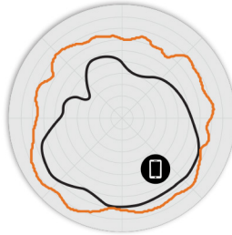
3. ábra R670 5GHz-es Azimuth (vízszintes irányú) antenna mintázatai
