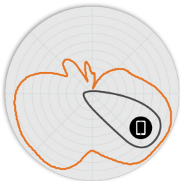
5. ábra R670 2,4 GHz-es Elevation (függőleges irányú) antenna mintázatai
