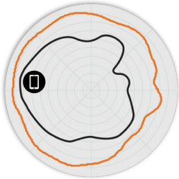
2. ábra R670 2,4 GHz-es Azimuth (vízszintes irányú) antenna mintázatai
