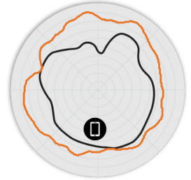
4. ábra R670 6GHz-es Azimuth (vízszintes irányú) antenna mintázatai
